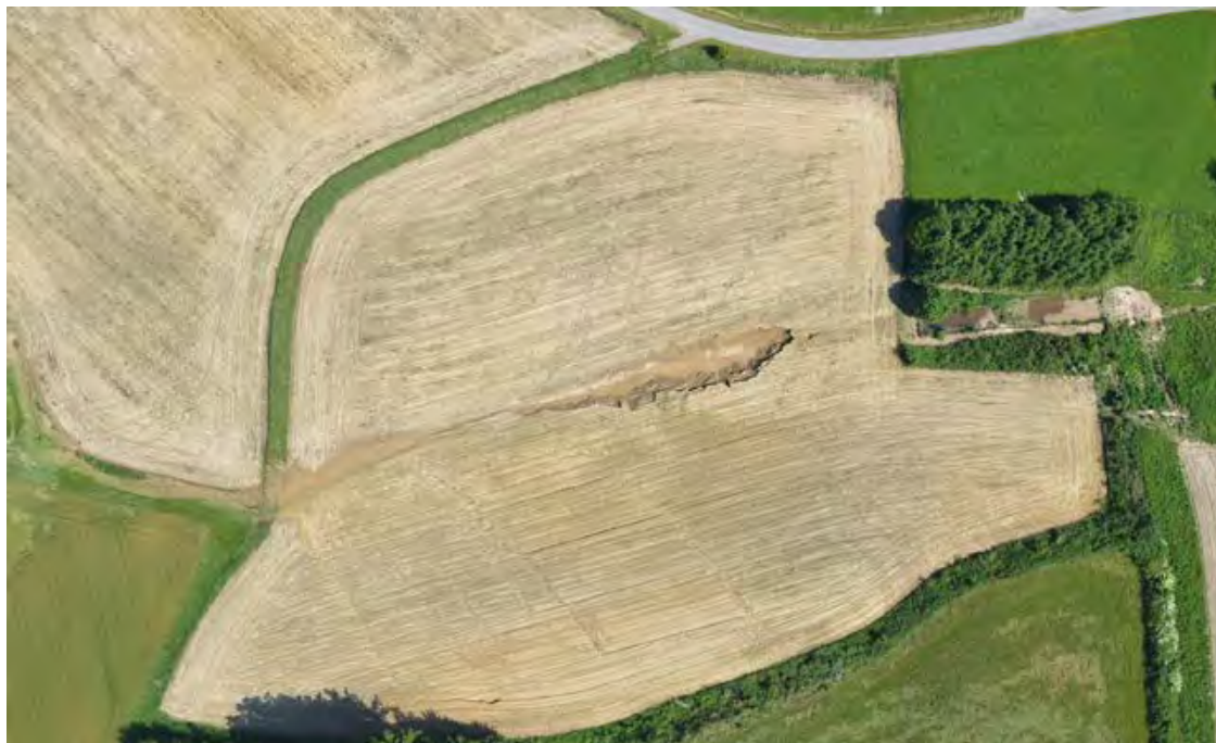
Abb. 41: Luftbild zur Auskolkung der folgenden Abbildungen, Abfluss aus einem V-Tälchen am rechten Bildrand über die kleinen Teiche nach links ins Maisfeld (westlich des Simbach-Einzugsgebiet), Luftbildaufnahme am 07.06.2016, W. Bauer, Agroluftbild Obertraubling
