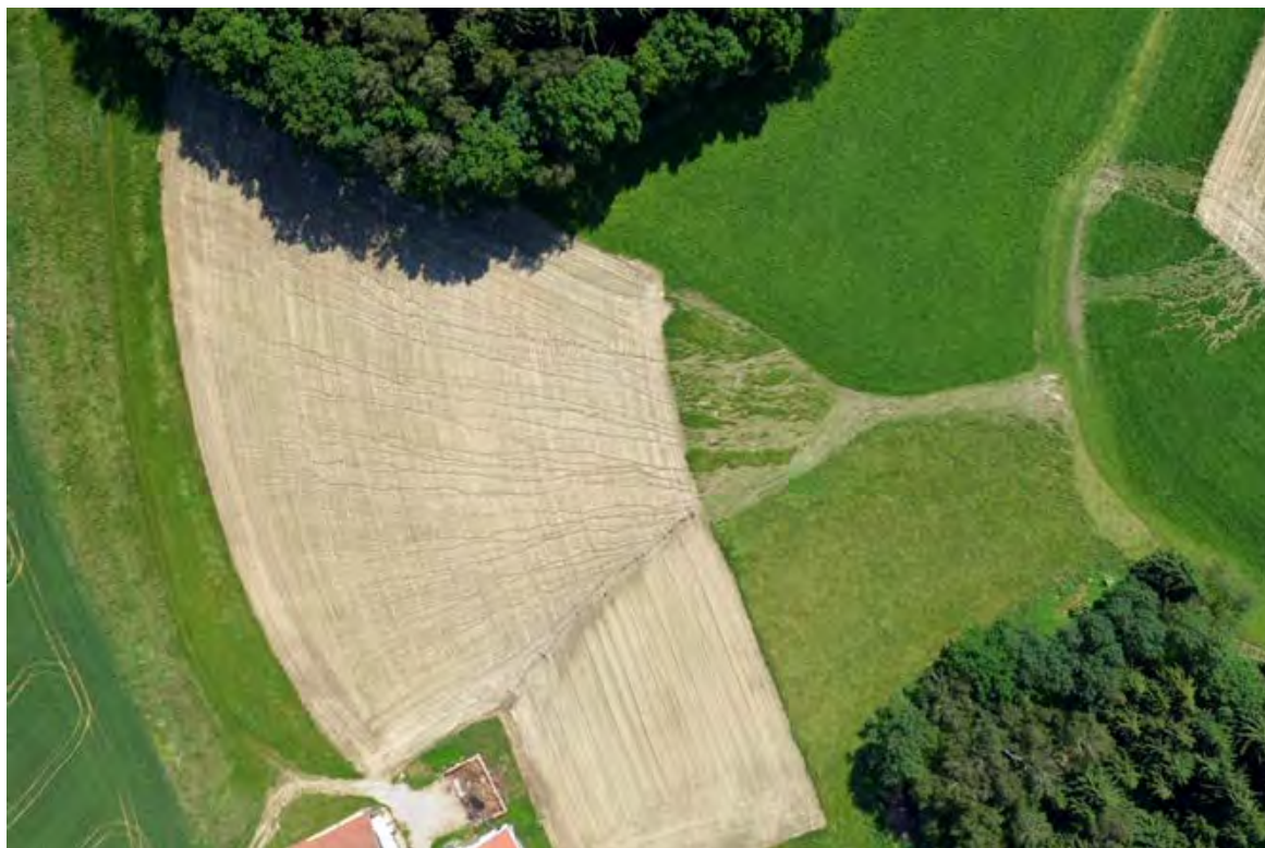
Abb. 38: Erosion beginnt im Maisfeld, Abfluss bündelt sich dann im Talweg (Einzugsgebiet Simbach) Luftbildaufnahme am 07.06.2016, W. Bauer, Agroluftbild Obertraubling
