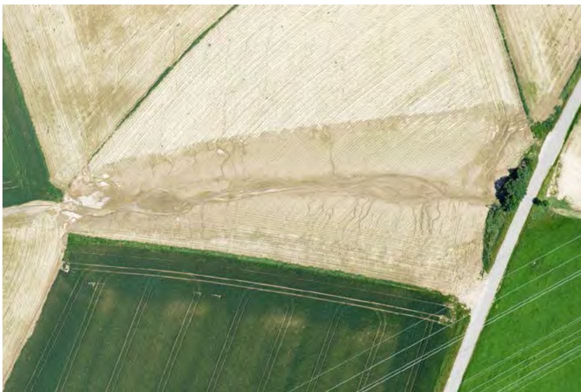
Abb. 49: Überfluteter Talweg, Abfluss nach rechts, Rückstau wegen teilweise verstopftem Straßendurchlass rechts (Einzugsgebiet Tannerbach), Luftbildaufnahme am 07.06.2016, W. Bauer, Agroluftbild Obertraubling
